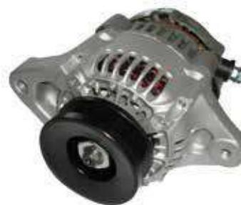
16.6727 alternatore 12V/40A - rotazione dx - c/puleggia
