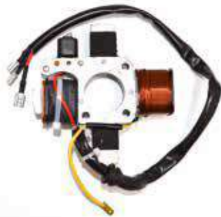
16.4152 statore elettronico 4 poli, 2 bobine c/pick-up
