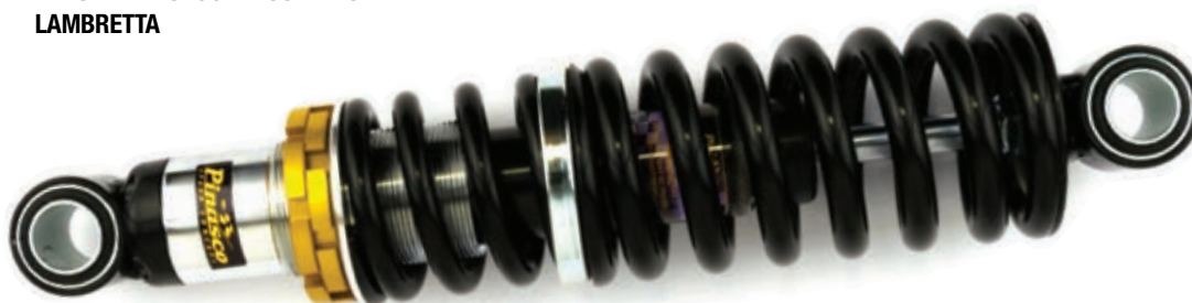
28441014 AMMORTIZZATORE PINASCO POSTERIORE NERO BLACK REAR SHOCK ABSORBERS LAMBRETTA
