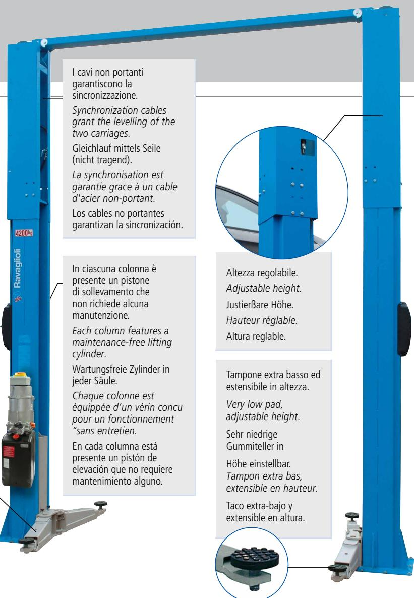
Perfetta sincronizzazione dei carrelli indipendentemente dalla ripartizione del carico. Valvole di sicurezza nei confronti di sovraccarichi e rottura di tubi idraulici. Valvola di controllo della velocità di discesa.
