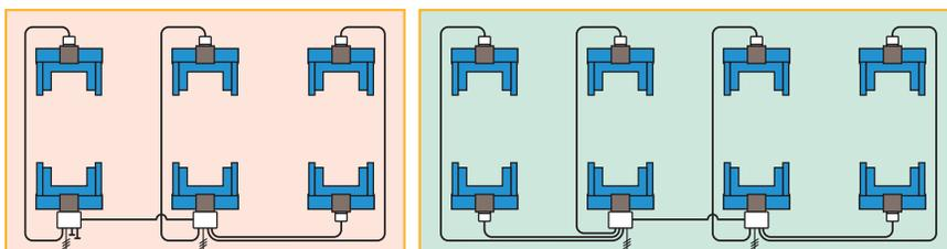
Impianti elettrici modulari per consentire successive variazioni sulla configurazione (es. passaggio da 4 a 6 o 8 colonne. Utilizzo di due set da 4 colonne ottenuti separando un set da 8 colonne...).
