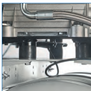
Base gruppo/motore montata su 4 antivibranti in gomma per ridotte vibrazioni, riduzione rumore e maggior durata (solo modelli Diesel).
