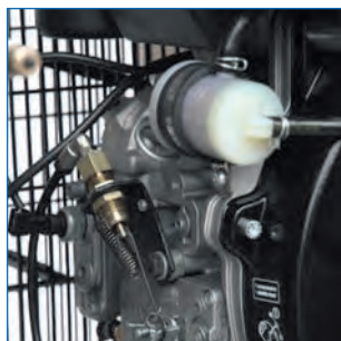
Dispositivo che riduce la velocità del motore per funzionamento a vuoto
