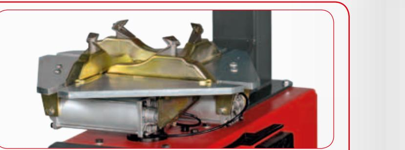
Le 4 griffe autocentranti sono controllate da due cilindri di diametro 80 mm dando al sistema una maggiore sicurezza di aggancio del cerchio. L'altezza del cuneo di presa dal piatto permette il bloccaggio di ruote di veicoli commerciali. Two locking cylinders of 80 mm diameter control the 4 self-centring jaws, so that the rim is perfectly and strongly clamped on the turntable. Moreover, the height of the wedges on the turntable plate allows the clamping of commercial vehicles wheels.
