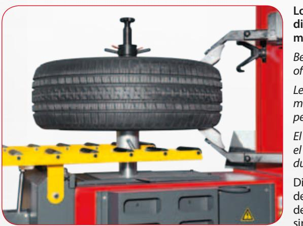
Lo stallonatore è l'utilizzo combinato dei due bracci a rulli idraulici e del movimento di traslazione dell'autocentrante. I due rulli sono di aiuto e necessari in fase di montaggio e smontaggio dei pneumatici.
