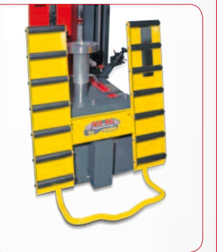
Il sollevatore è posto di fronte all'autocentrante mobile, quando si ribalta e posiziona la ruota in modo orizzontale il foro del cerchio si trova sempre in linea con il centro dell'autocentrante. Risolve in modo veloce ed efficace il problema delle ruote pesanti.
