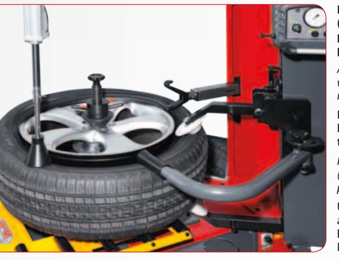
Per agevolare le operazioni di montaggio è dotato di un secondo braccio (indispensabile per ruote di grande diametro). E' fornito inoltre di un terzo punto di pressione (braccio mobile Helper), che segue la rotazione del pneumatico.
