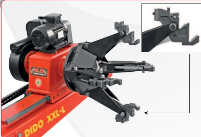
■ **Autocentrante universale idraulico a 4 griffe sviluppato per bloccare tutti i tipi di cerchi con presa diretta da 14"-42" (fino a 60" con prolunghe - optional). La nuova griffa è stata progettata con n° 5 prese di bloccaggio, di cui una è un piano di presa mobile che si adatta a qualunque tipo di forma interna del cerchio. Due velocità per ogni senso di rotazione. Presa diametro minimo foro centrale: 115 mm.**
