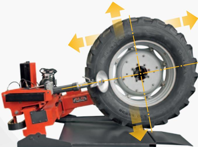
■ **Smontagomme elettroidraulico superautomatico a movimentazione sincronizzata dei carri, ideato per operare su ruote da camion, autobus, agricole e da movimento terra. Progettato con la tecnologia di lavoro "sempre in tangenza": il disco e l'unghia si trovano sempre nella corretta posizione, garantendo così una maggiore facilità e rapidità delle operazioni di smontaggio e montaggio, una maggiore sicurezza per l'operatore e la salvaguardia del pneumatico e del cerchio.**
