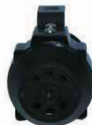
09.6010 avvisatore retromarcia "Mitsuba" Ø 44 c/staffa funzionamento a 12/24/36/48V - C.C. intensità sonora 85 +/- 10 Db (1 metro) frequenza 3.000 +/- 500 Hz frequenza impulsi 90 +/- 30 colpi/minuto
