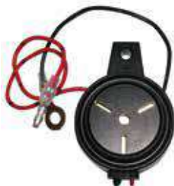
09.7395 buzzer giapponese Nikko Ø 48 mm. 12/24V - c.c. - 95 dB/2.600Hz 70/100 C/M
