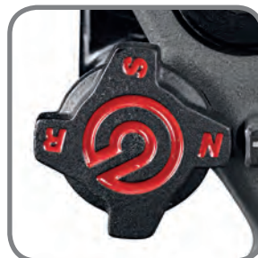
Selettore per la regolazione delle tre mappe. Selector for the adjustment of the three settings.
