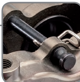
Perno con clip di sicurezza. Pin with safety clip.
