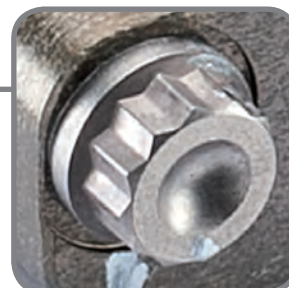
Montaggio a mano e oggettivazione delle coppie di serraggio delle viti. Hand assembly and objectification of screw tightening torques.
