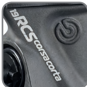
Logo "RCS Corsa Corta" lavorato al laser. Laser etched "RCS Corsa Corta" logo.
