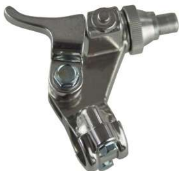
BRACCIALE FRIZIONE 4T KAWASAKI KX250F 2005-2009 CON LEVETTA DECOMPRESSORE
