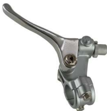
BRACCIALE FRIZIONE HONDA CRF 150 4T CON LEVETTA DECOMPRESSORE
