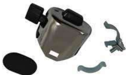
02.9707 commutatore luci 3 posizioni cromato da manubrio Ø 22 c/pulsante claxon e pulsante arresto
