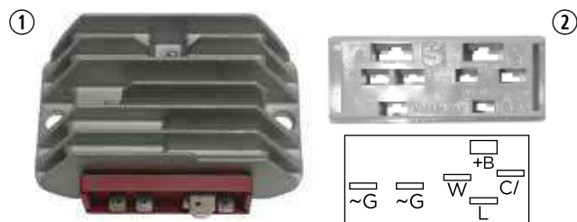
16.7258 regolatore Saprisa 24V/20A - monofase a ponte - 6 faston - morsettiera rossa - c/circuito spia e terminale W per attacco contagiri (fig. 1)
