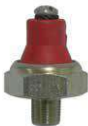
02.7834 bulbo pressione olio (pressostato) esagono 24 - 1/8 gas - vite superiore M4
