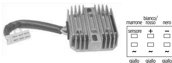
17.2068 regolatore DZE 12V - trifase - c.c. - 6 cavi - c/sensore
