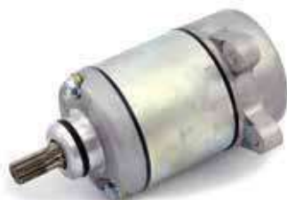
17.81039 motorino 12V - rotazione sx - 9 denti
