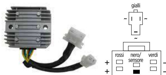
17.2079 regolatore DZE 12V - trifase - c.c. - 8 cavi - c/sensore - 2 connettori
