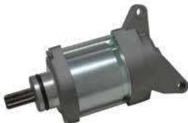
17.81123 motorino 12V - 9 denti - rotazione dx
