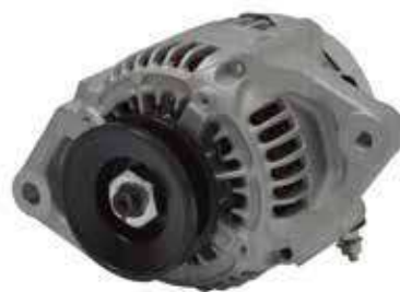
16.6722 alternatore 12V/55A - rotazione dx
