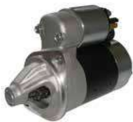
17.81121 motorino 12V/1,0Kw - 8 denti - rotazione dx
