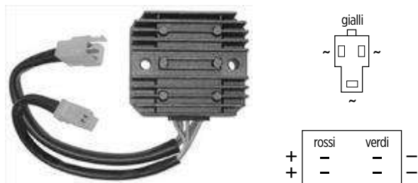
17.2061 regolatore DZE 12V - trifase - c.c. - 7 cavi - 2 connettori
