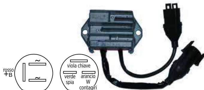
16.7436 regolatore Saprisa - 12V/30A c.c. - monofase a ponte - 6 cavi - c/spia - c/terminale W per contagiri - cablaggio c/connettori tondi
