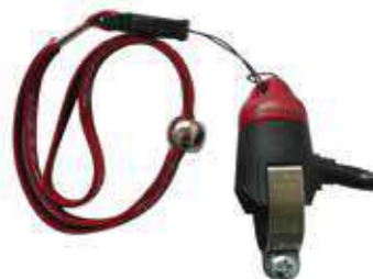
02.9710 dispositivo di sicurezza magnetico arresto motore "Leonelli" a/fascetta - c/cavi - cablaggio 600 mm. c/2 capocorda (1 occhiello/1 faston femmina)
