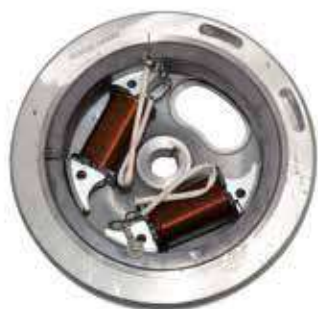
16.3509 rotore completo c/bobina alimentazione e bobina illuminazione
