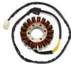
16.9016 statore 18 poli trifase - s/pickup
