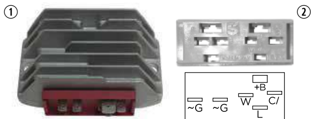
16.7236 regolatore Saprisa - 12V/30A c.c. - monofase a ponte - 6 faston - c/spia - c/terminale W per contagiri (fig. 1)
