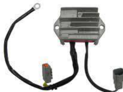
16.7448 regolatore Saprisa - 12V/30A - monofase a ponte - c/cavi e connettori Deutsch - c/circuito spia
