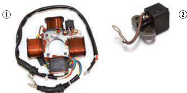
16.3032 statore elettronico 4 poli, 4 bobine - c/pick-up (fig. 1)
