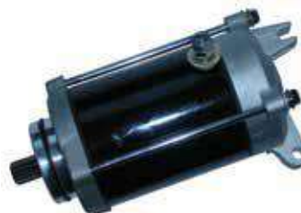
17.81101 motorino 12V - 10 denti - Ø 12,4 - rotazione sx
