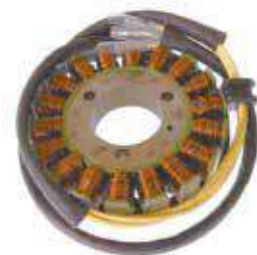
16.3049 statore 18 poli trifase - s/pick-up - 103x38x20
