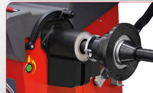
3D Scan version per la ricezione in automatico dei dati di distanza e diametro cerchio,
